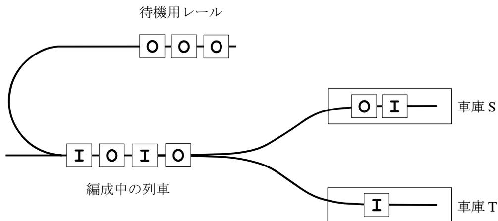
図: 列車を編成している途中で、このとき車庫にある車両を待機用レールに移すことはできない。
